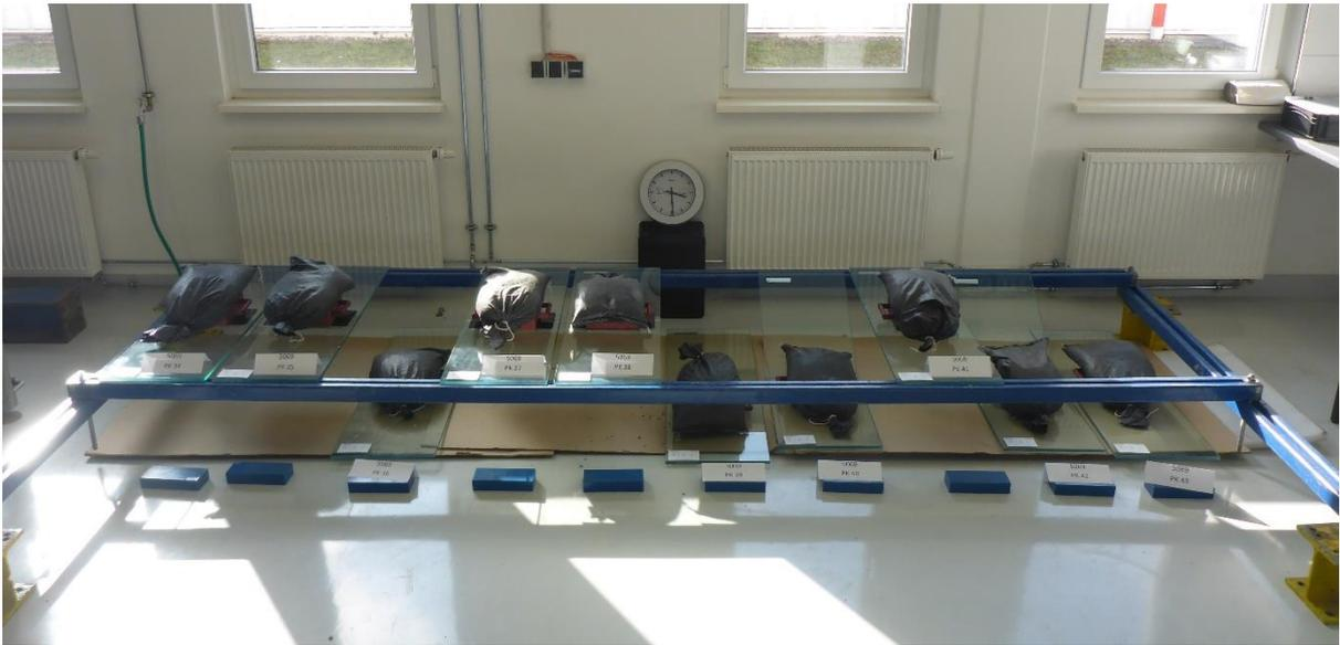
Abb. 5 Resttragversuch bei Versuchsende
