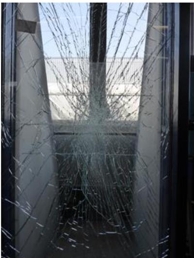
Abb. 3 Bruchbilder; Proben ohne Zellen (PK 29-33)
