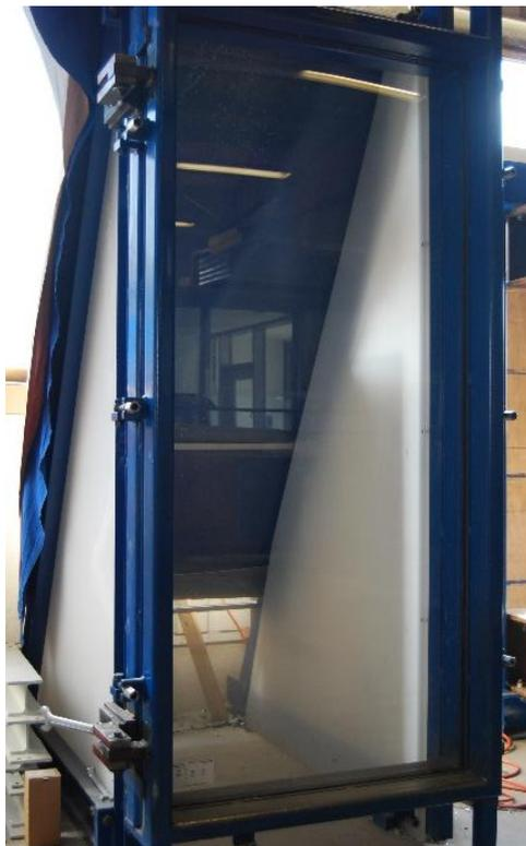
Abb. 1: Pendelschlagprüfstand nach DIN EN 12600
